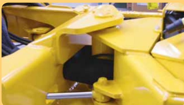
Telaio in acciaio ad alta resistenza elettrosaldato snodato con ponte anteriore oscillante per una maggiore stabilità e doppio martinetto per una manovrabilità più rapida e confortevole.
