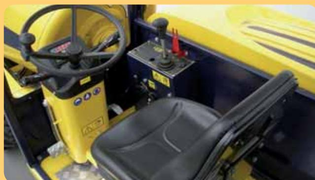
Dotata di cabina aperta ROPS. Con posto di guida reversibile di 180° per una migliore visibilità in fase di carico dei materiali. Può essere dotata di vetratura trilaterale o cabina chiusa con riscaldamento.
