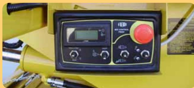
Unica nella sua categoria con dispositivo MIX CONTROL di serie. Flussometro contalitri digitale per la programmazione dell'acqua nell'impasto, per lo start/stop della pompa dell'acqua e per la rotazione del tamburo. Il tutto in un unico piccolo quadro di comando posto in prossimità della canale di scarico. Le stesse operazioni si possono eseguire dalla cabina.
