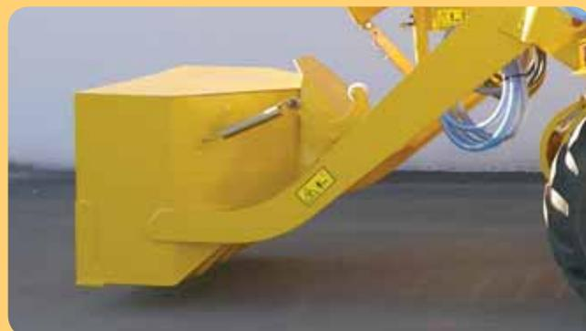
Anche se di piccole dimensioni il modello DB 180 offre un alto standard di dispositivi al servizio dell'operatore e viene dotata di serie con la chiusura automatica meccanica della pala di carico per evitare perdite di materiali nella fase di scarico dentro il tamburo.
