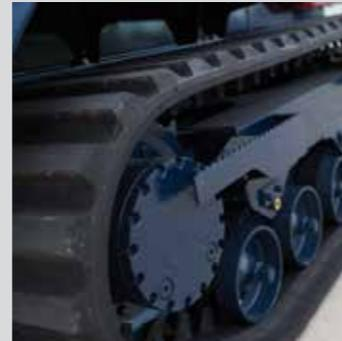
Cingolo in gomma con registro automatico della tensione
