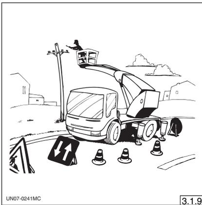
E' vietato operare con la macchina quando il vento raggiunge una velocità superiore a 12,5 m/s (grado 6 della scala di Beaufort).
