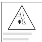
**D7** - Indica la pressione massima esercitata sul terreno dallo stabilizzatore e la reazione massima che deve esercitare il terreno per sostenere la macchina.
